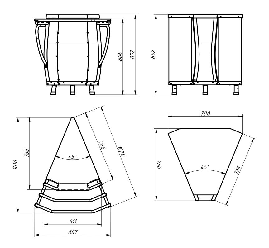
Модули поворотные предназначены для установки линии прилавков самообслуживания с поворотом на 45° (наружным поворотом или внутренним поворотом). Модуль имеет регулируемые по высоте ножки. Внутренний поворотный модуль внизу имеет нейтральный шкаф для хранения кухонного инвентаря. Наружный поворотный модуль имеет направляющие для подносов (входят в комплект поставки).
